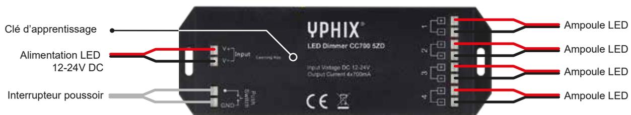
Option 1. Contrôlez le récepteur LED CC 700 5ZD avec une télécommande RF Télécommande RF (Code produit : 50208610)
